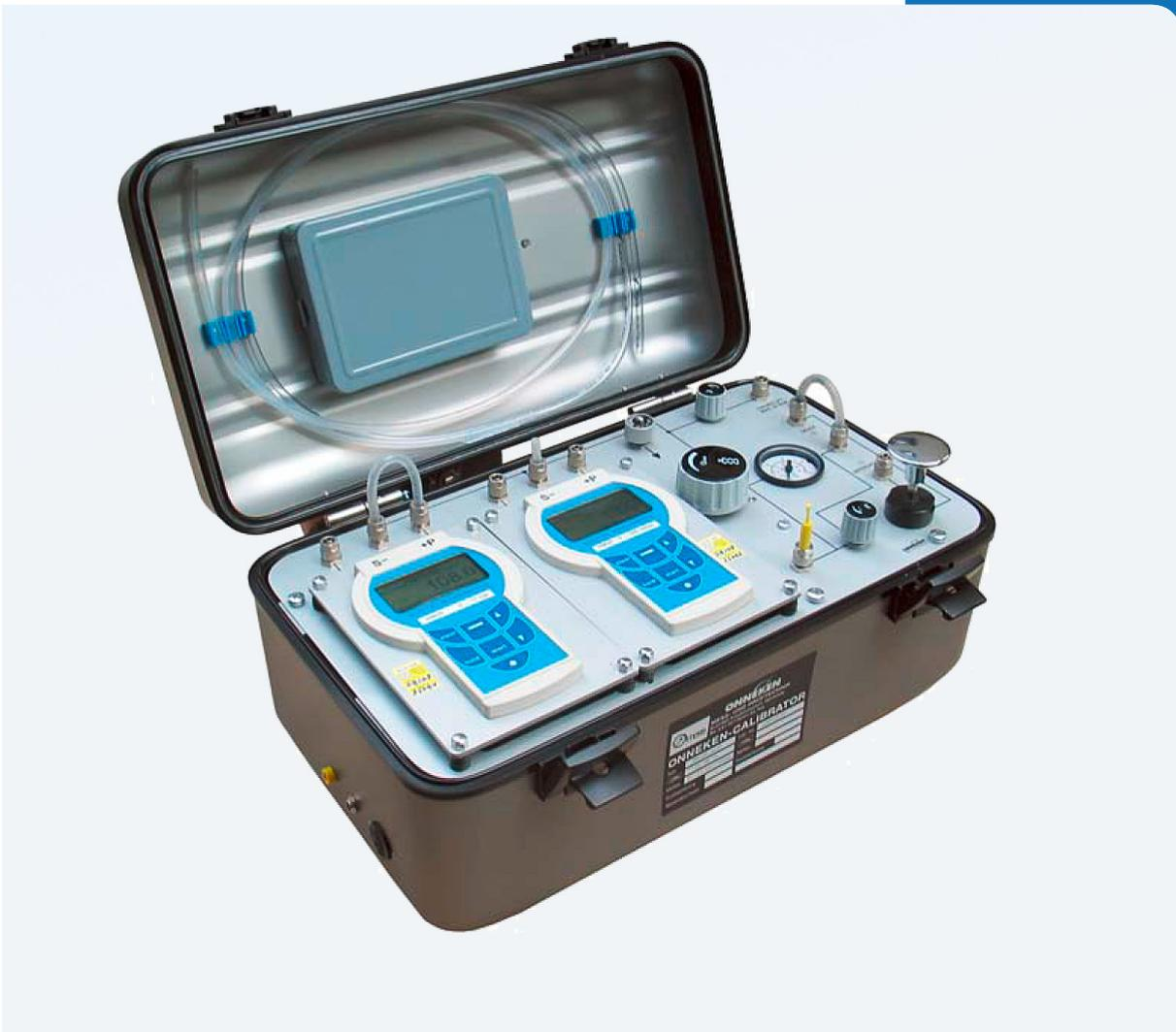
Der tragbare Omess-Calibrator OM-DM 422S ist sehr handlich. Er findet seine Anwendung in der Prüfung und Kalibrierung von Druckmeßumformern. Aus einer vorhandenen Druckanlage kann über den Fremdlufteingang extern Druck eingespeist werden. Auf dem integrierten, analogen Kleinmanometer wird der erzeugte Druck direkt abgelesen. Dies erleichtert die Simulation mit digitalen Anzeigegeräten.
